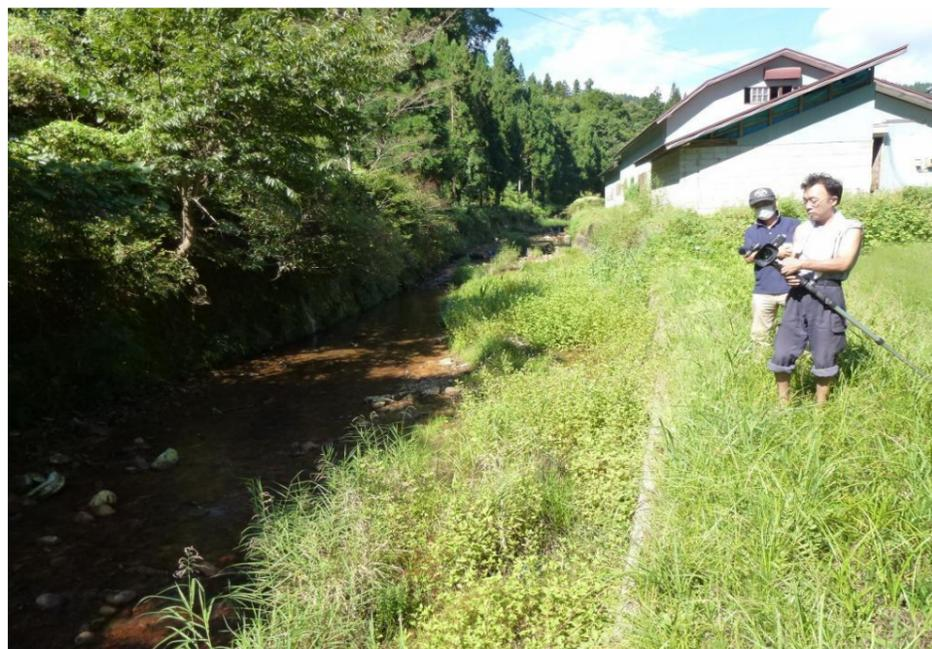
写真1 取水口建設想定地点付近を下流側から遠望。右上に見える牛小屋より上流側で取水し、水圧管路は牛小屋と川の間から写真撮影地点付近を通して町道に回すことを想定している。
