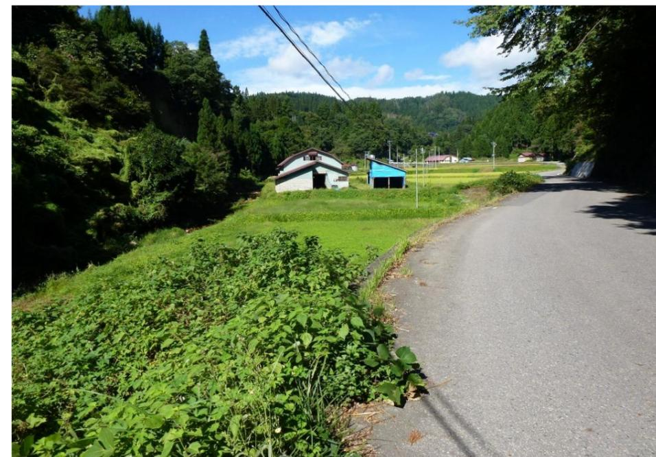
写真2 地点⑤付近から取水口想定地点方向を望む。水圧管路は畦の下などに埋設し、この付近から町道に埋設する想定である。
