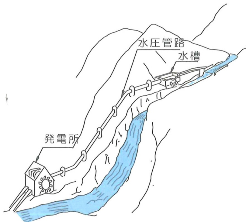
図Ⅱ-4 取水後すぐに水圧管路に接続し、道路に沿うなどして敷設する工法
